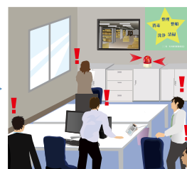
アラーム入力を受け、回転灯が点灯して異常を知らせます。
