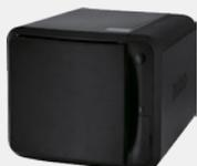
NSV6シリーズは、機密性に優れた録画映像の保存、共有などに優れたNASベース型のNVRです。RAID0、RAID1、RAID10に対応しているため、処理性能の向上やハードディスクの故障によるデータ損失を防ぐことができます。録画映像のクラウドストレージとしても活用できます。
